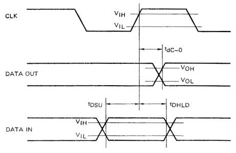
$t_{dC-0}$  : 2  $\mu s$  MAX. (RL=33  $k\Omega$  , CL=15 pF)
