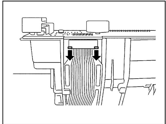
11. Install Meter Circuit Plate No. 3.
